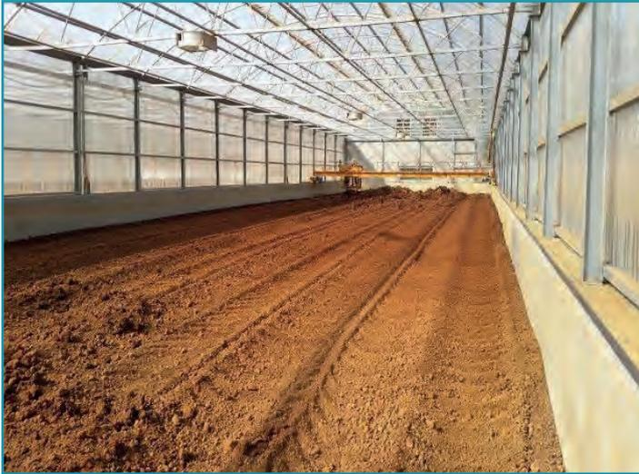
*Séchage solaire des boues (source : CCGST)*
