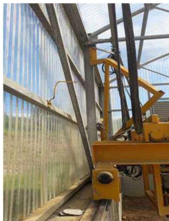
Des ajustements de position des fins de courses et la reprise du nombre de boucles des câbles ont été nécessaires, certaines soudures de l'IPN sur lesquels sont posés les chariots ont été effectuées afin de fiabiliser le fonctionnement des ponts. Deux interventions de nuit ont été nécessaires pour la réhabilitation des châssis endommagés.
