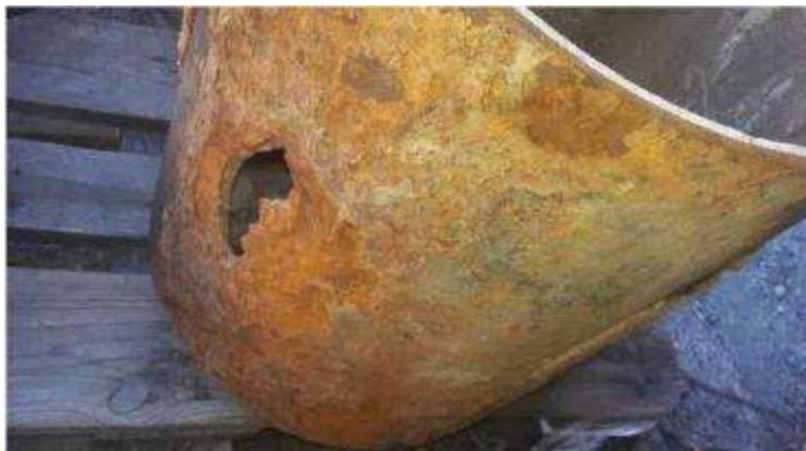
En 2019, Veolia a lancé un diagnostic complet de cette conduite afin d'étudier sur l'ensemble du linéaire le risque d'une nouvelle casse. Un profil en long a mis en évidence le passage de la conduite en sous œuvre de plusieurs cadres pluviaux. Chaque franchissement a été analysé afin de vérifier la profondeur de la conduite d'eau potable et la proximité d'eau de mer. Au final, seul le passage en sous-œuvre au droit de la fuite présente un risque significatif.
