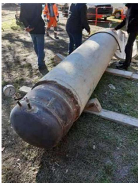
Une portion « intègre » de la canalisation ayant rompu a été fermée par l'ajout de fonds bombés métalliques par soudure. L'ensemble est mis en pression jusqu'au seuil de rupture, l'essai est suivi sur le manomètre présent sur la photographie.
